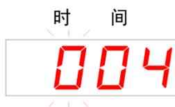
显示值，按【>】键移动要设定的显示位。设定完毕后按【确认】键进入下一步设定。
